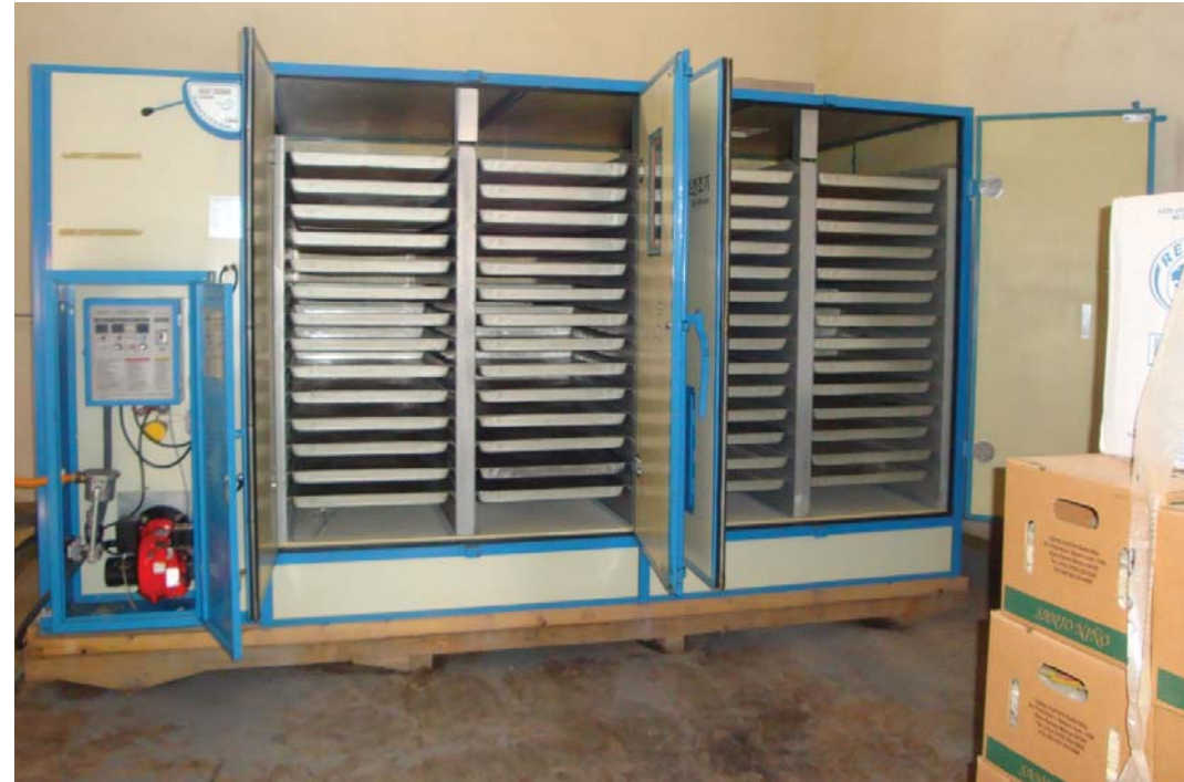
Deshidratadora de gas LP.
