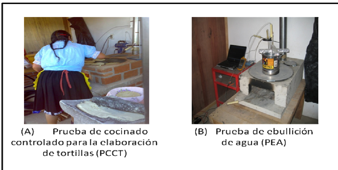
Figura 2. Pruebas de cocinado controlado de tortillas y prueba de ebullición de agua (DGCENICA, 2008).
