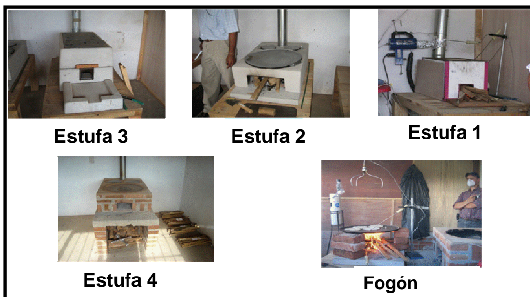
Figura 1. Estufas mejoradas y fogón tradicional evaluados en condiciones controladas (DGCENICA, 2008).
