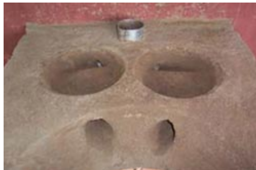
Foto 2. Túneles y hornillas secundarias
