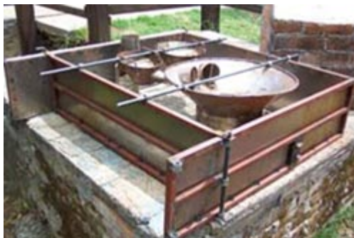
Foto 6. Molde para la construcción de estufa Patsari
