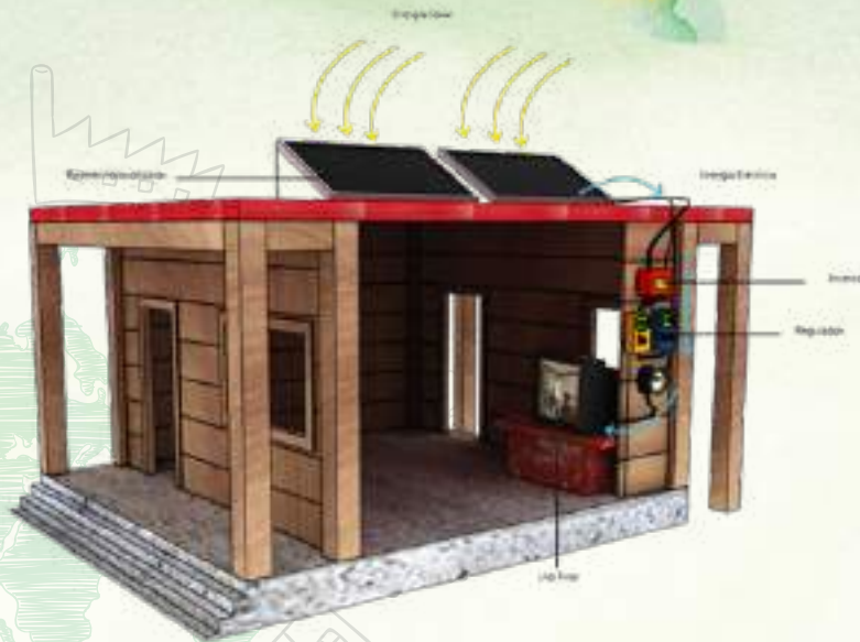
Imagen 20. Componentes de un sistema fotovoltaico montado en una vivienda. Para poder utilizar la energía generada en los paneles, es necesario contar con un inversor y un regulador de la energía eléctrica. Imagen de la Unidad de ecotecnologías, 2020.
