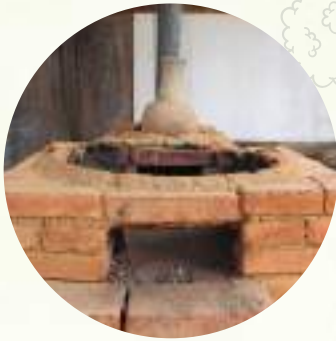
Imagen 1. Estufa Lorena, acrónimo de "lodo y arena", Oaxaca 2022. Esta estufa es un modelo precursor de la Estufa Patsari y fue difundida ampliamente en países como Guatemala en la década de 1990. Imagen de Ana Laura Morales García.
